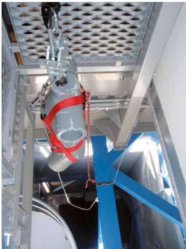
Prova di caduta di un'imbracatura nell'ufficio R&D di C.A.M.P.
